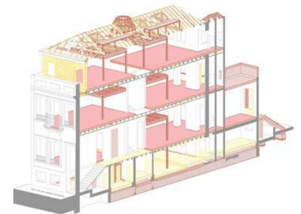
MODELO BIM ESTRUTURAS STRUCTURAL BIM MODEL
