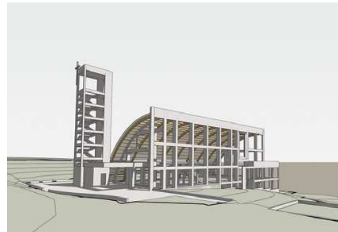
MODELO BIM ESTRUTURAS STRUCTURAL BIM MODEL
