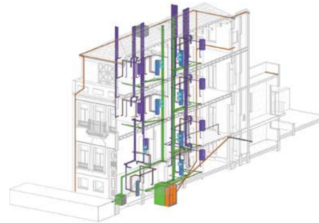
MODELO BIM INSTALAÇÕES TÉCNICAS MEP BIM MODEL
